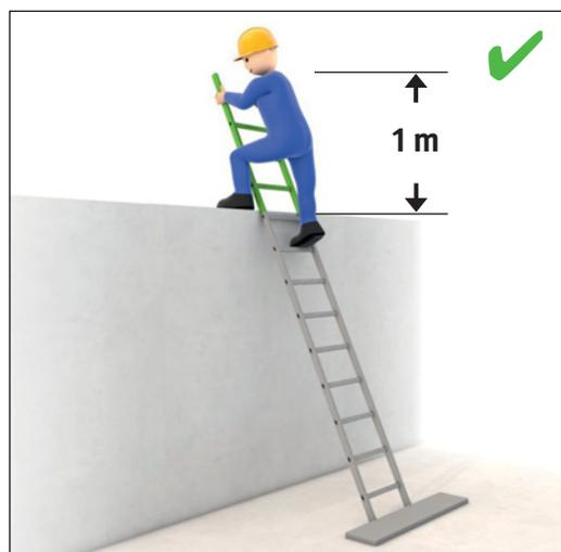
Escada com comprimento suficiente
